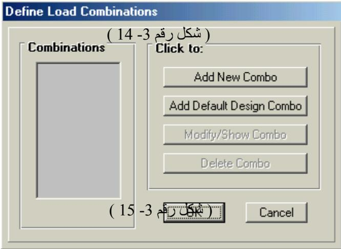
\* لتعريف حالة التحميل COMB1 = DL + LL + WL نختار أمر Load Combination من قائمة Define فيظهر مربع الحوار (شكل رقم 3-15) فننقر زر Add New Combo فيظهر مربع الحوار (شكل 3-16) حيث نحدد به :-
